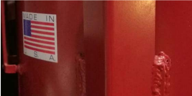
Abbildung 2: Die Konformitätsvermutung und ihre Grenzen: Schweißnaht der Fusskonstruktion an der drucktragenden Wand eines Behälters, CE-gekennzeichnet, nach ASME Code gebaut. Der Betreiber plant Betrieb mit Lastwechseln.
