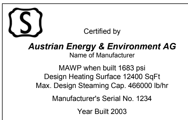
Bild 4: Kesselschild nach ASME Section I
