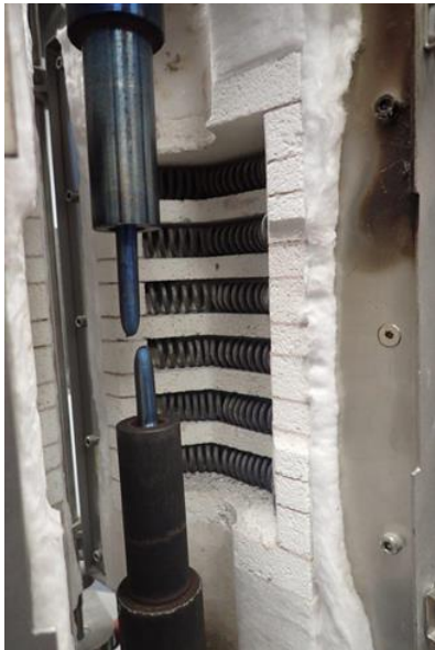
Abbildung 6: Zugprobe aus 1.0571 in der Heizkammer der Zugmaschine nach dem Versuch. Quelle: BGH Edelstahl Siegen GmbH.
