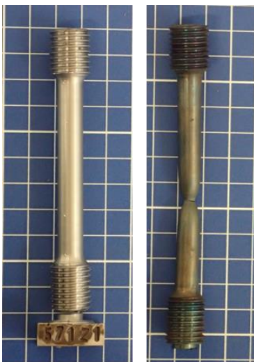
Abbildung 3: Rundzugprobe aus dem Material 1.0571 vor und nach der Erprobung bei 400°C, es wurden R_{p0,2} 292 MPa und R_m 474 MPa ermittelt. Die markierten Messpunkte um die Mitte der Probe dienen zur Ermittlung der Bruchdehnung. Quelle: BGH Edelstahl Siegen GmbH.
