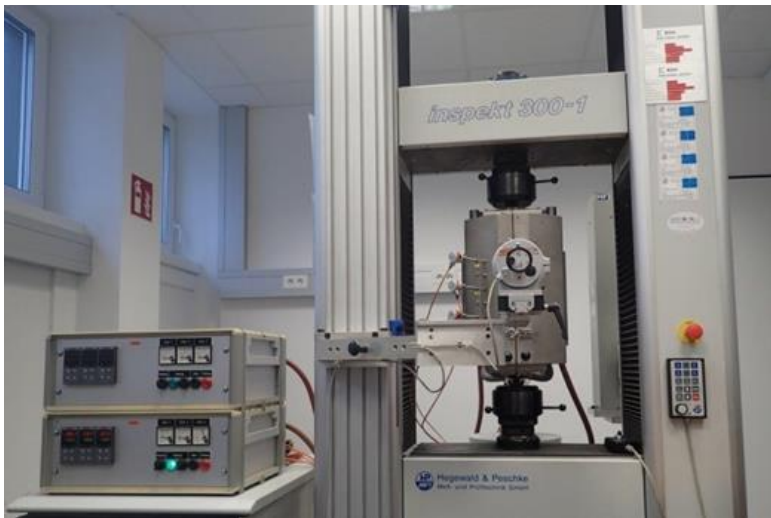
Abbildung 1: Zugmaschine für Warmzugversuche, Quelle: BGH Edelstahl Siegen GmbH. Die Probenaufnahme ist von einer Heizkammer umgeben, links ist die Energieversorgung und Steuerung der Heizung angeordnet.
